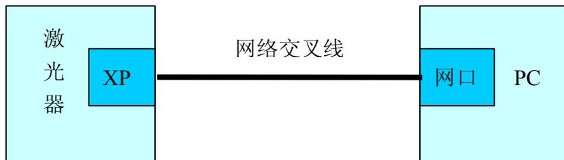
图 1 手动操作模式连线图
