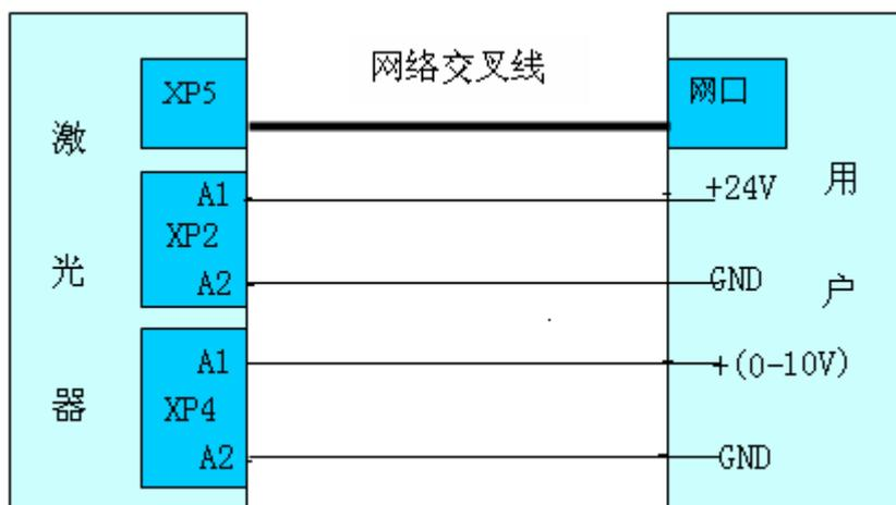
图 3—模拟量控制连线图
